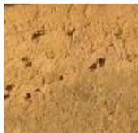
La terre crue, ou **torchis** est un mélange d'argile, de fibres végétales (paille de lin en général), de chaux (liant) et d'eau. Appliqué sur une structure en bois et parfois recouvert d'un enduit de chaux blanc, le torchis est un matériau de construction bon marché et facile d'utilisation. Il fut très répandu dans les campagnes pour la construction des bâtis agricoles mais ne subsiste aujourd'hui que sous forme résiduelle.
