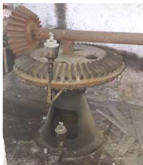
Turbine pouvant être remise en état pour de la production d'énergie © AUD
